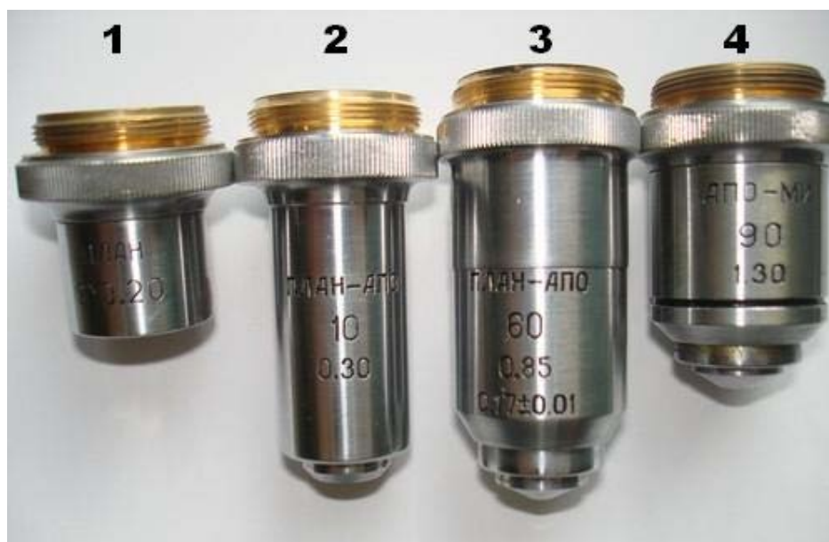
Рис. 1. Типы объективов микроскопа 1 – планахромат малого увеличения; 2 и 3 – планапохроматы; 4 – апохромат иммерсионный
