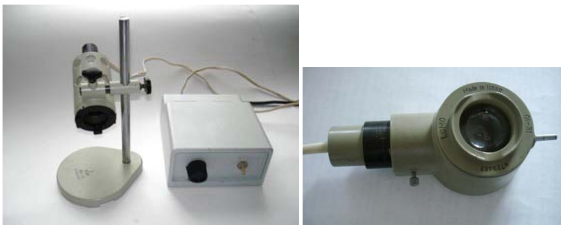
Рис. 4. Типы осветителей ОИ-19 – слева, ОИ-31 – справа
