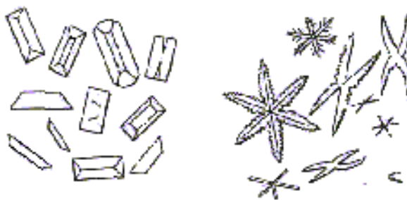
Рис. 5. Кристаллы фосфата магния-аммония, полученные при медленной (слева) и быстрой (справа) кристаллизации
